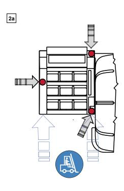
Note: DO NOT LIFT THE WHEEL BALANCER USING OTHER GRIPS
