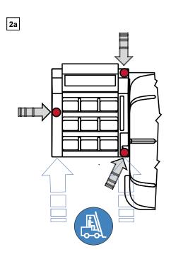
Note: DO NOT LIFT THE WHEEL BALANCER USING OTHER GRIPS
